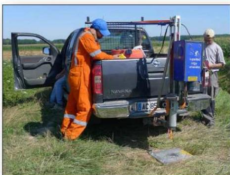
Acquisition sismique réfraction
