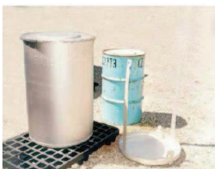
Fût enrobé bitumineux (à gauche : surfût inox)
