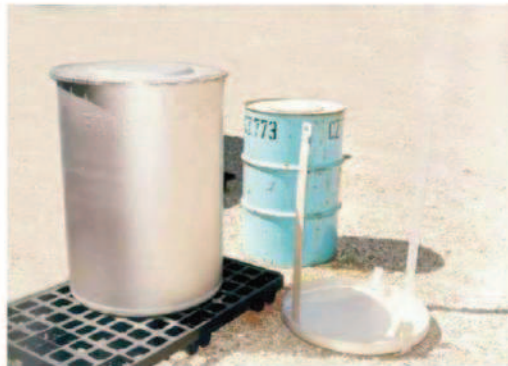
Fût enrobé bitumineux (à gauche : surfût inox)
