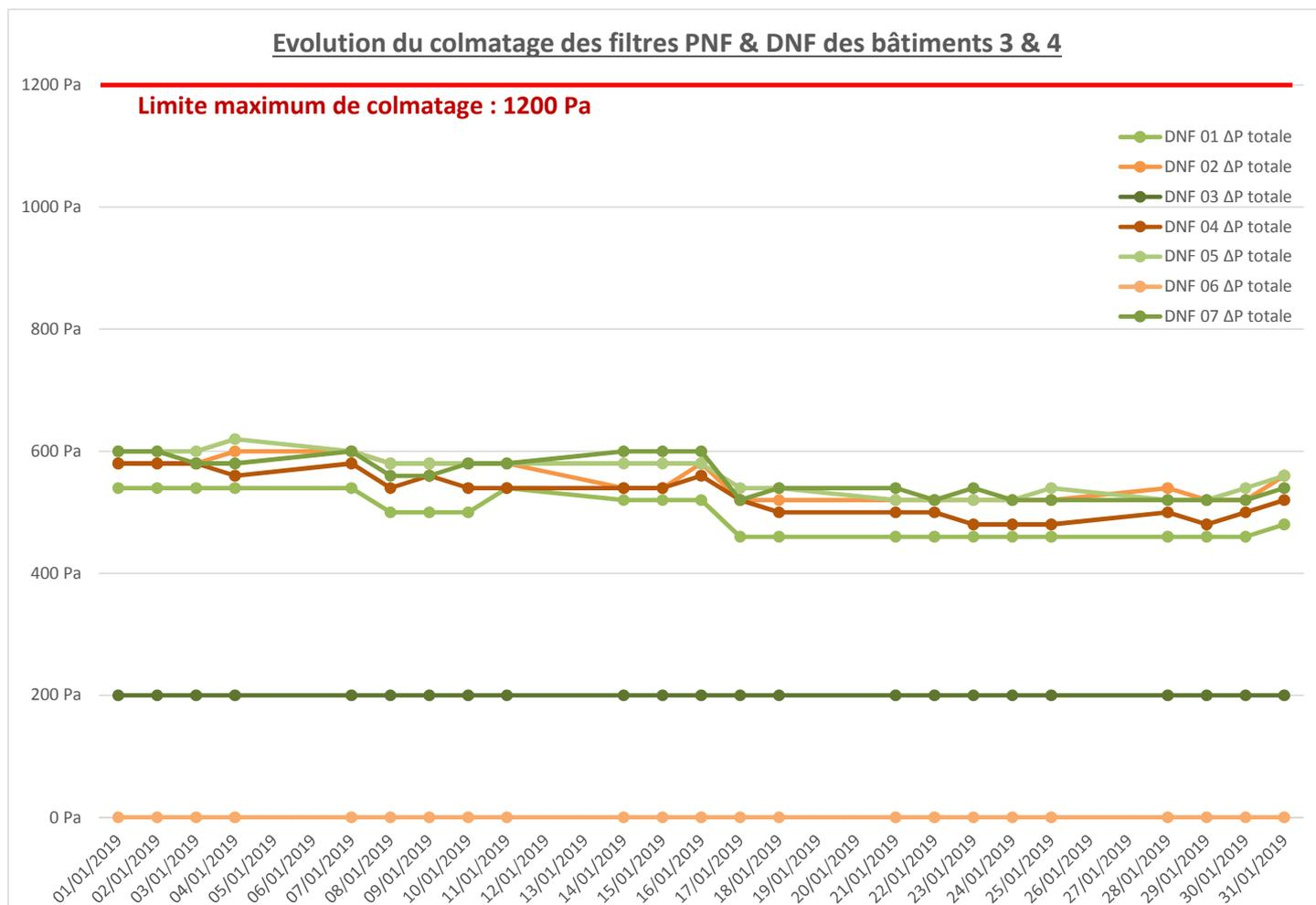
Le dernier changement des 7 filtres THE de première barrière, a été réalisé le 12 décembre 2018. Le suivi de colmatage des filtres THE se fait par filtre pour chaque ligne (2 filtres THE par ligne, et 7 lignes de filtration).
