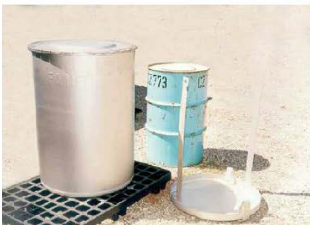
Fût enrobé bitumineux (à gauche : surfût inox)
