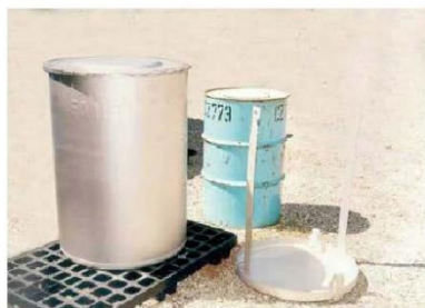
Fût enrobé bitumineux (à gauche : surfût inox)
