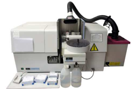
Spectrophotomètre d'Absorption Atomique avec Atomisation Electrothermique
