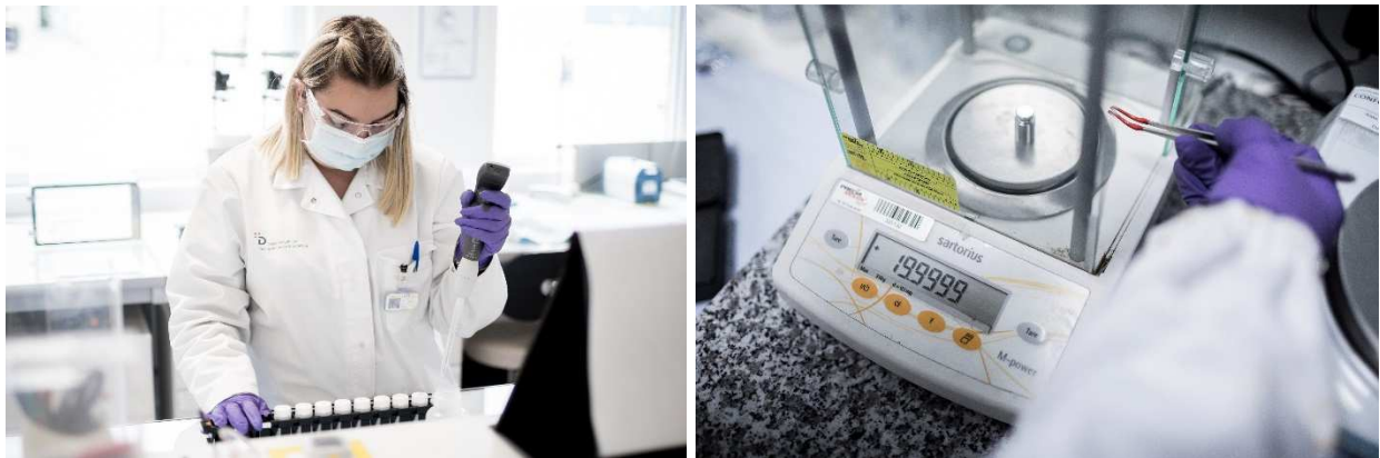
Figures 23 : Laboratoire DAHER implanté sur l'ICPE Préparation d'échantillons pour mesures de l'activité du tritium, & vérification périodique de la balance de précision
