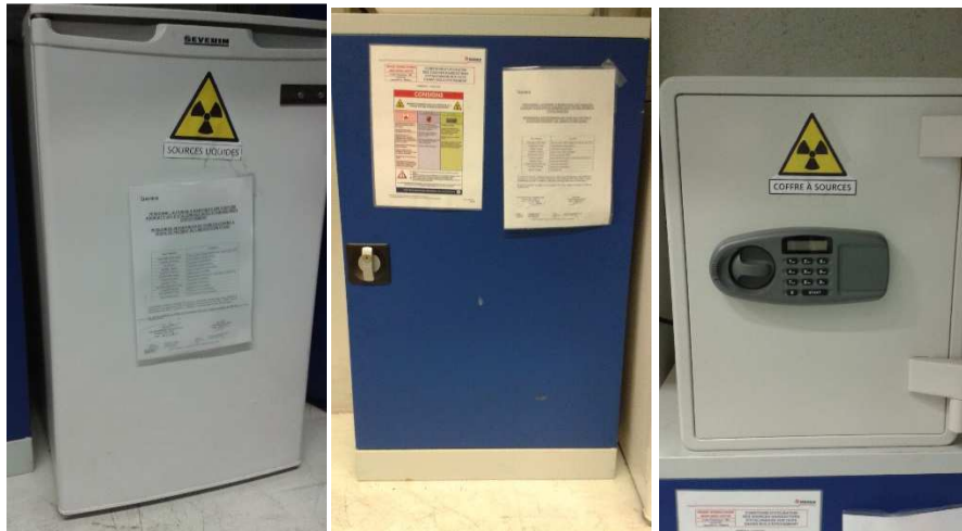
Figures 22 : Réfrigérateur de conservation des sources non-scellées, coffres à sources scellées découvertes lors du tri de déchets, et coffre à sources scellées détenues par DAHER sur l'ICPE
