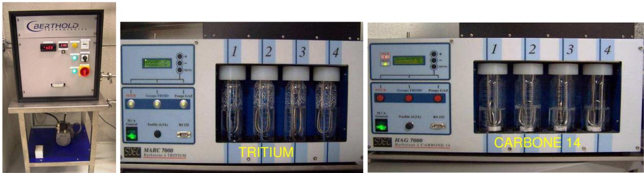
Figure 9 : Préleveur d'aérosols & d'iode 129, barboteur tritium, et barboteur pour carbone 14. Prélèvements dans les effluents gazeux après les filtres THE & avant le rejet à la cheminée
