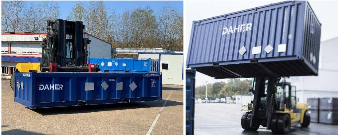
Figure 18 : Chariots élévateurs 32 tonnes
