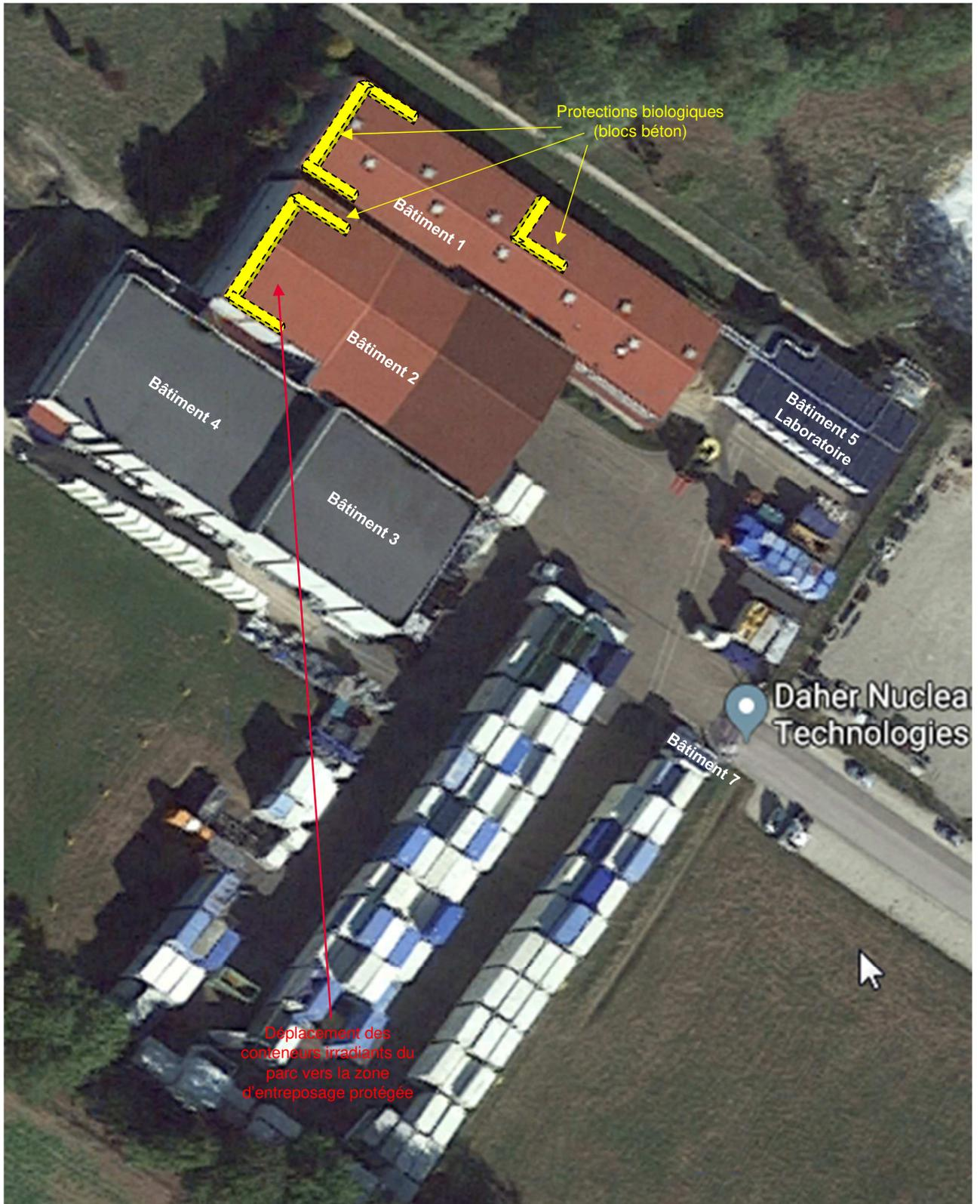
Figure 4 : ICPE telle qu'exploitée en 2021, installations
