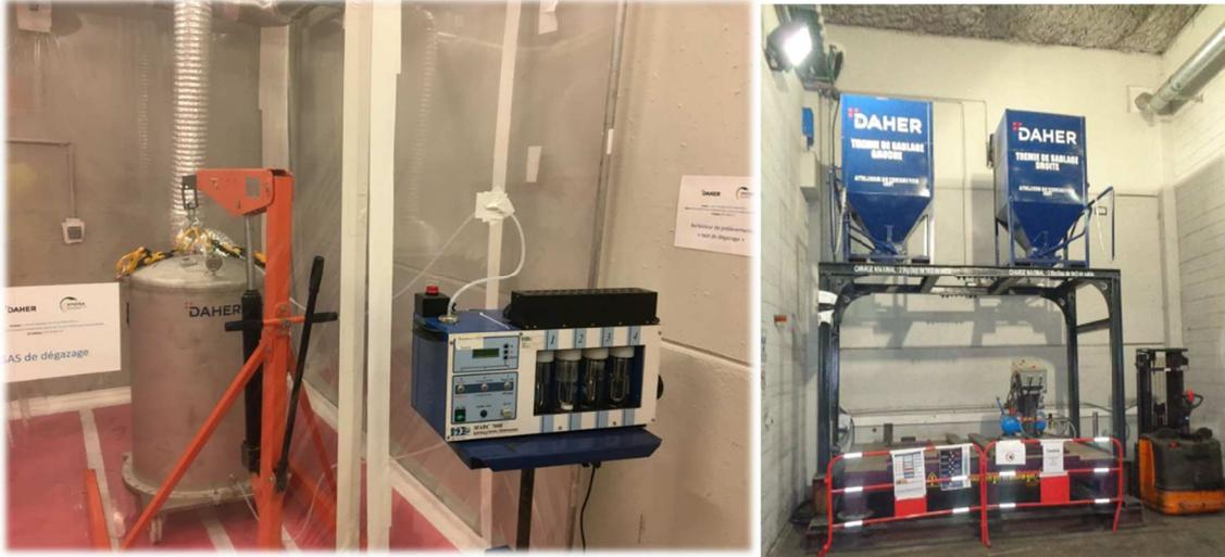
Figures 23 : aménagement du SET-PV pour dégazage, et zone d'ensablement des colis finis de déchets amiantés
