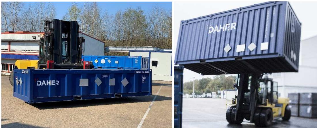
Figure 18 : Chariots élévateurs 32 tonnes
