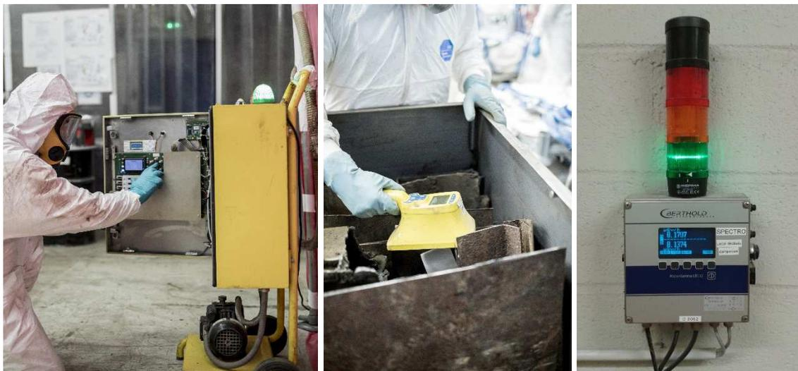
Figures 24 : Moyens de surveillance de radioprotection, Balise de détection des aérosols radioactifs, contaminamètre portable, balise de détection d'exposition externe
