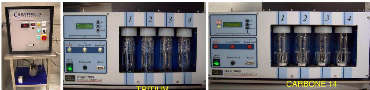
Figure 9 : Préleveur d'aérosols & d'iode 129, barboteur tritium, et barboteur pour carbone 14. Prélèvements dans les effluents gazeux après les filtres THE & avant le rejet à la cheminée
