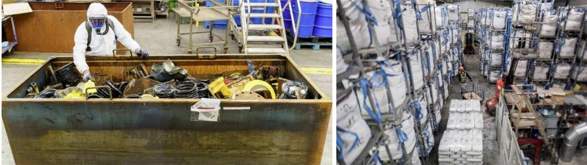
Figures 20 : déchets triés et reconditionnés, prêts à être expédiés vers l'ANDRA, Déchets métalliques en casiers et déchets gravats en Big-Bag
