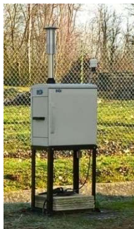
Figure 5 : Préleveur d'air environnemental
